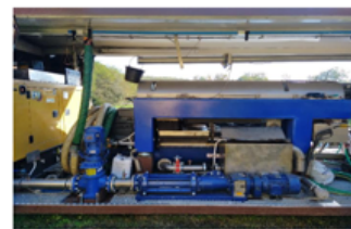
Benne étanche d'homogénéisation des boues au premier plan et centrifugeuse pour la déshydratation des boues au second plan Centrifugeuse
